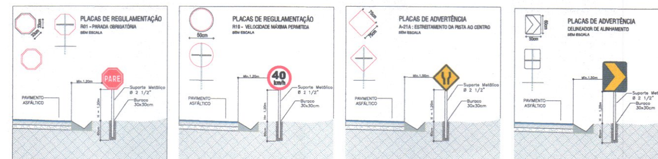
DETALHAMENTOS DA SINALIZAÇÃO VERTICAL ESC.: 1/150
